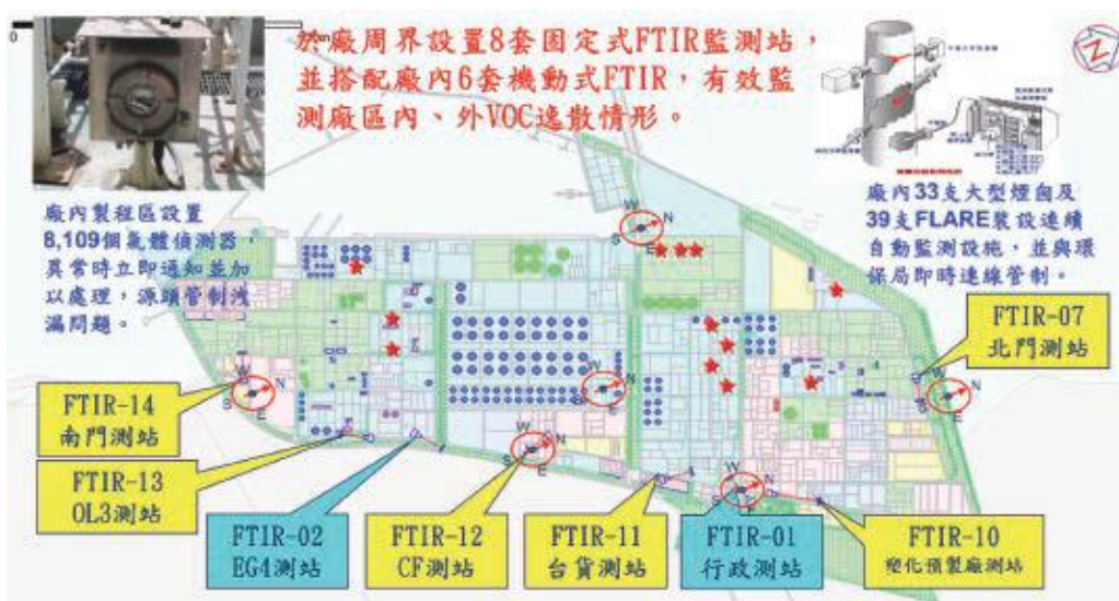
廠區內監測設備設置地點
