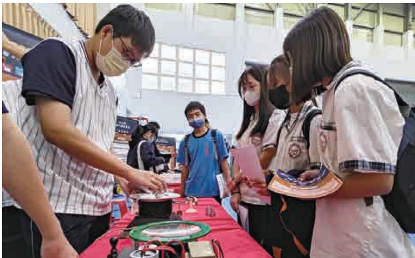
哥倫布蛋關卡：使雞蛋狀的銅塊在旋轉磁場中，因陀螺效應站立
