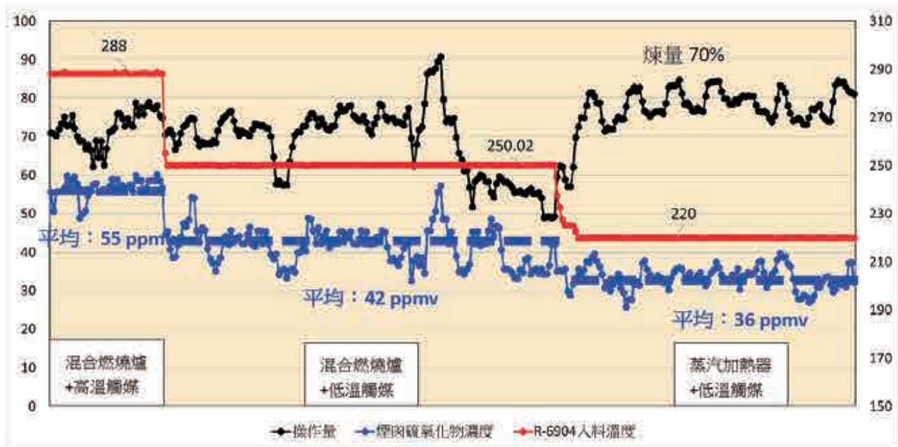
圖六 改善前後氫化反應器操作溫度及煙囪硫氧化物濃度趨勢圖
