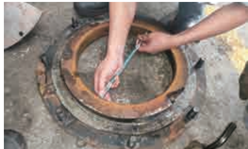
量測擋水板內孔的公差尺寸， 依實際公差尺寸重新設計並製 作擋水板
