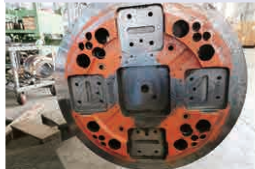
OUTBOARD 與 SHAFT 組裝面 結合良好
