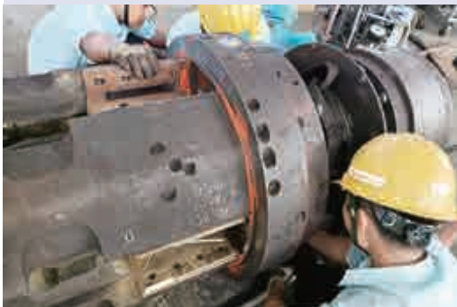
OUTBOARD 與 SHAFT 組裝面 用紅丹粉檢查
