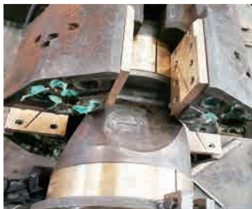
圖五 Wedge Cap 使用鋼板增加固定點並變更補強方式
