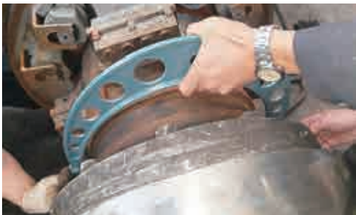
量測擋水板組裝處公差尺寸
