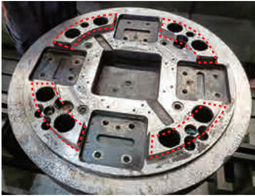
OUTBOARD 組裝面焊補後加工 (紅虛線處因生產時振動產生磨損)
