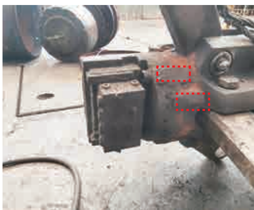
圖四 Wedge Cap 增加 4 個 Ø20 PIN 孔補強
