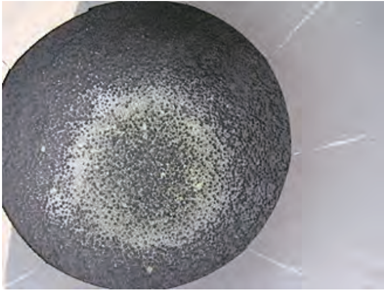
圖三 若定檢開槽反應器上層觸媒表面附著碳粉，需抽除篩分及更新上層十公分厚度的觸媒
