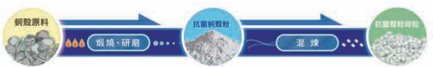
圖十二 台塑抗菌殼粉製造流程圖
