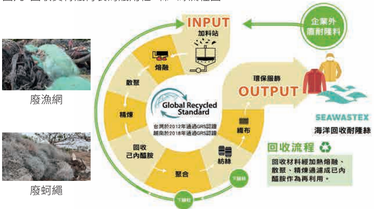
圖十 回收廢漁網、廢蚵繩再製為環保絲流程圖
