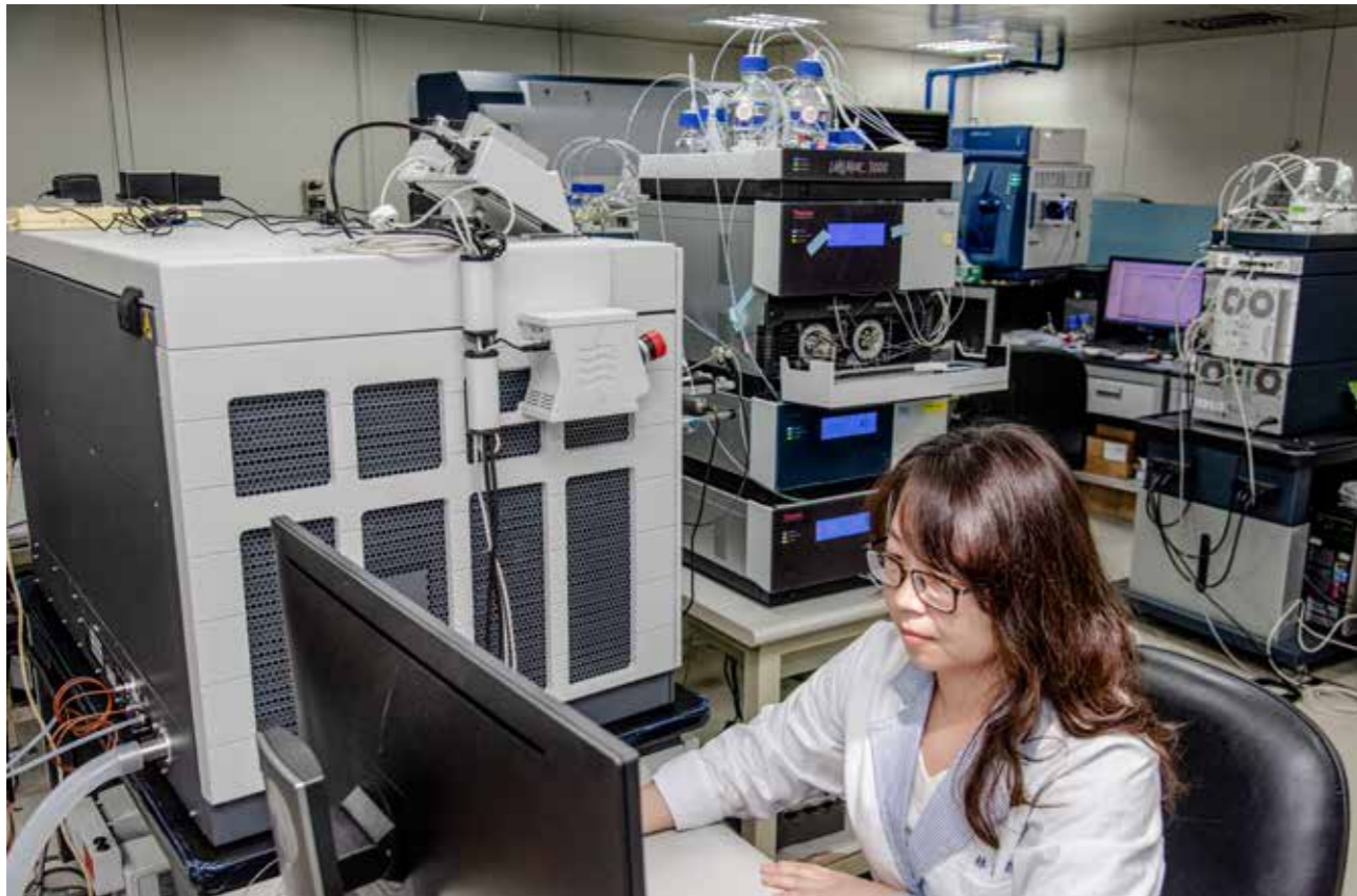
..... 分子醫學研究中心 - 傅立葉轉換電場軌道阱複合式質譜儀系統
