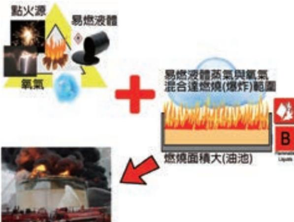
圖三 易燃性液體儲槽火災的發生條件
