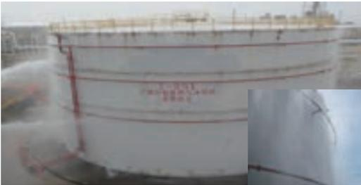
儲槽冷卻撒水系統測試
