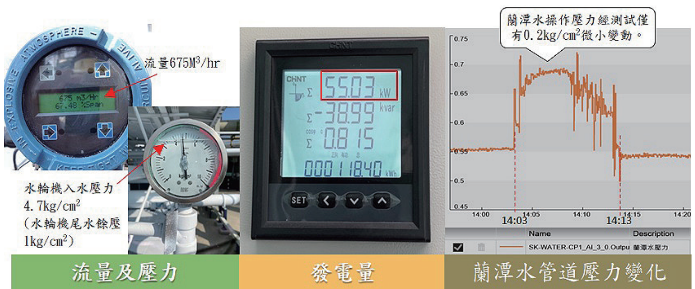
圖六 蘭潭小水力發電機性能測試數據
