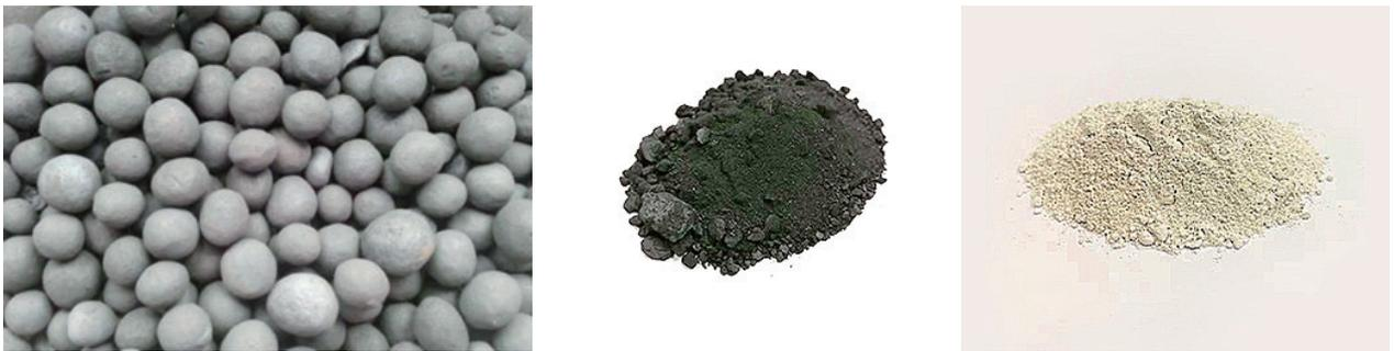
圖五 轉底爐產出之含鐵球團礦、粉鐵礦與氧化鋅粉示意圖
