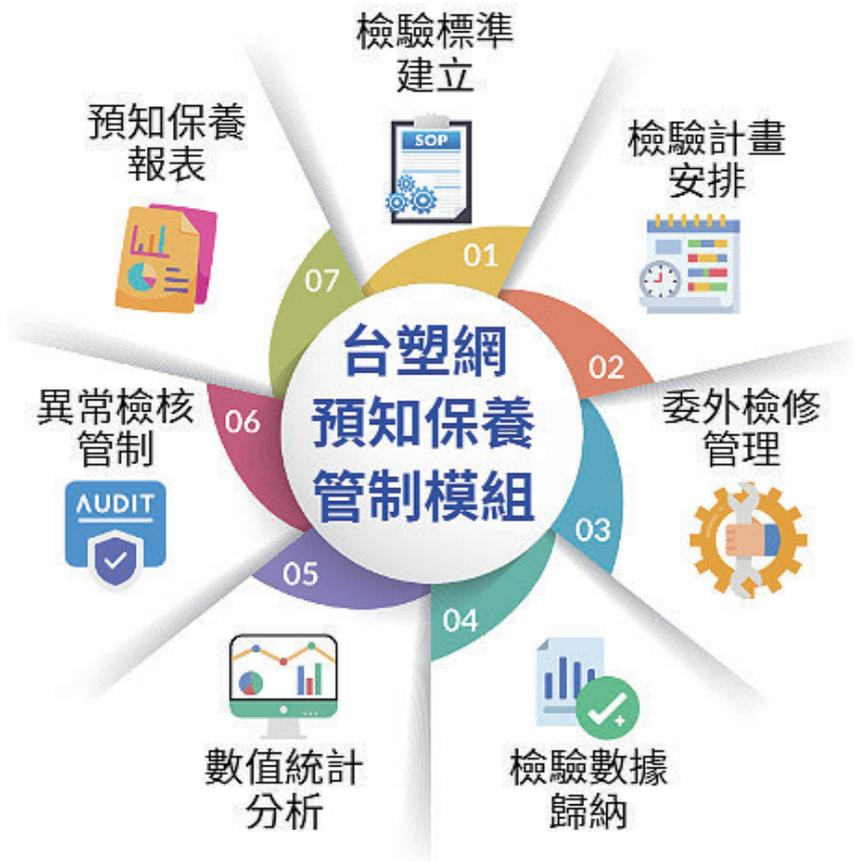
台塑網預知保養管理模組與廠內各項設備，包含電氣設備如局部放電檢測、變壓器油中氣體分析、紅外線熱影像檢測、高壓變壓器、UPS及充電機電池檢測、高壓電容器檢查、超音波檢測、紅外線熱影像溫度檢測等八種設備進行資料串接；機械設備如振動分析、油品分析、加熱爐熱影像等五種檢測與分析，透過計畫安排擬訂每月檢測項目與計畫，並透過實際檢測數據匯入，進一步掌握各設備檢測數據運行狀態之趨勢，並可針對趨勢劣化提前進行處置，與案件立案改善，由系統來協助管理預知保養工作。
