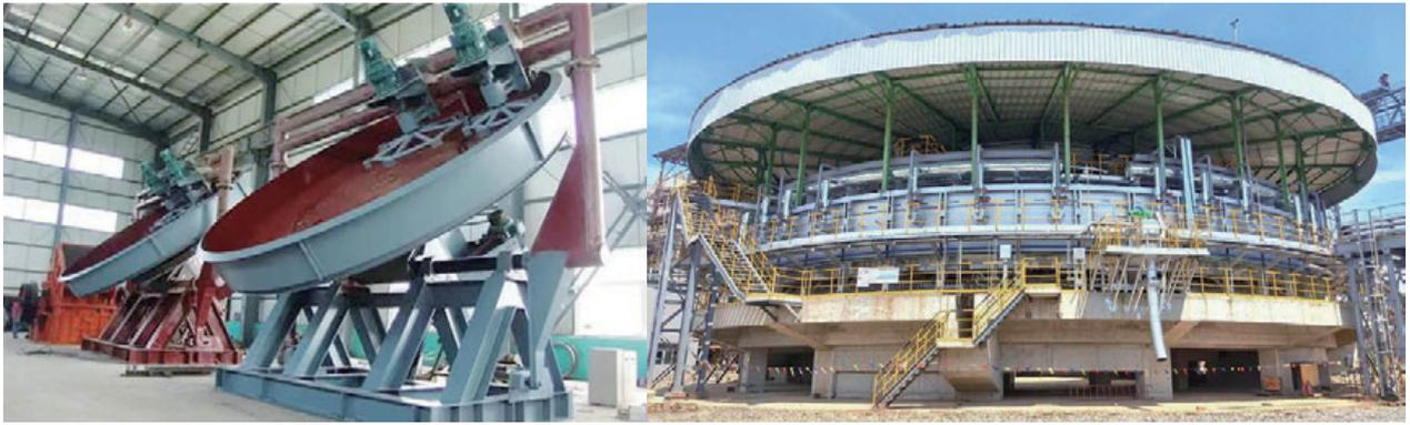
圖四 圓盤造球機 (左) 與轉底爐 (右) 示意圖
