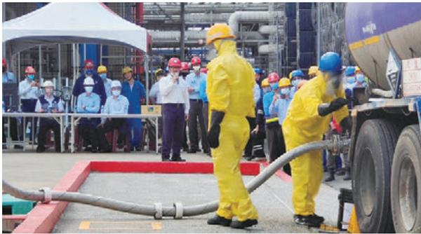
槽車卸料作業安全與異常影像辨識動態實務示範
