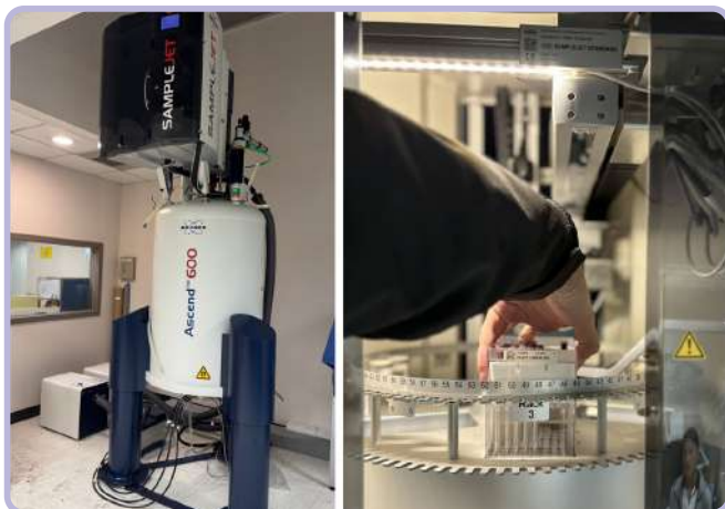
▲ 圖一：(左)核磁共振儀外觀，上方為 SampleJet 自動進樣器。(右)自動進樣器內部檢體實驗操作構造
