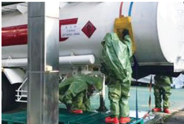
使用充氣止漏墊進行槽車破孔止漏
